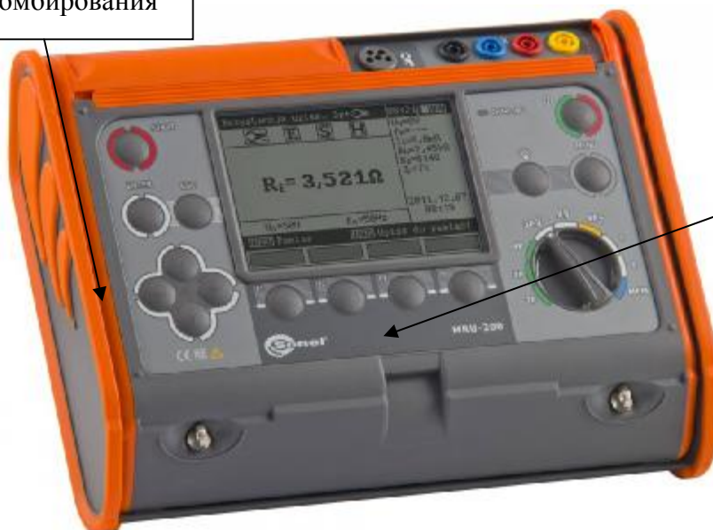
Рисунок 2 – Общий вид измерителей модификации MRU-200 с указанием мест нанесения знака поверки и пломбирования
